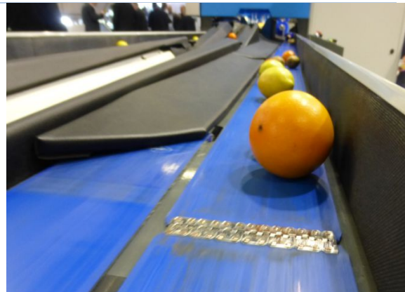
Esta foto muestra uso de grandes áreas de amortiguantes. Sin embargo la unión de las cintas es un broche metálico de muy difícil sanitización el cual no es recomendable frente a un escenario FSMA 117
