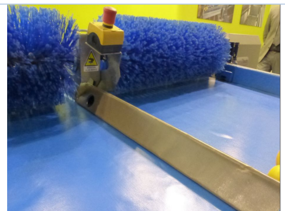
Recubrimiento de teflón utilizado en las barras separadoras de flujo
